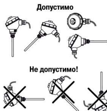
Рисунок 5.4 – Положение датчика при монтаже
